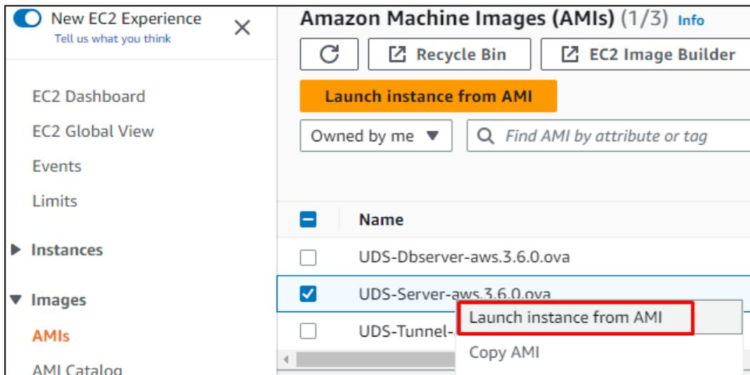
En el asistente de creación de instancia debemos escoger el tipo adecuado para cada componente de UDS. Los requisitos mínimos serán para todos los componentes (Dbserver, UDS-Server y UDS-Tunnel) de 2vCPUs y 2 GB de RAM.
